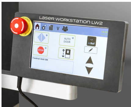
Intuitive Schnittstelle, Steuerung der Markierung mit Touchscreen
