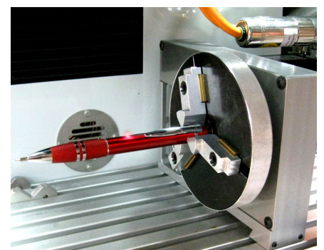
Drehvorrichtung für die zylindrische Teilekennzeichnung
