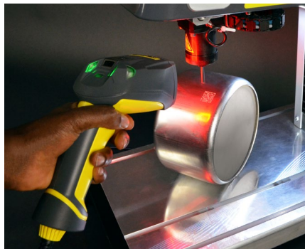
Tragbares Lesegerät zur sofortigen Lesbarkeitsprüfung der Markierung
